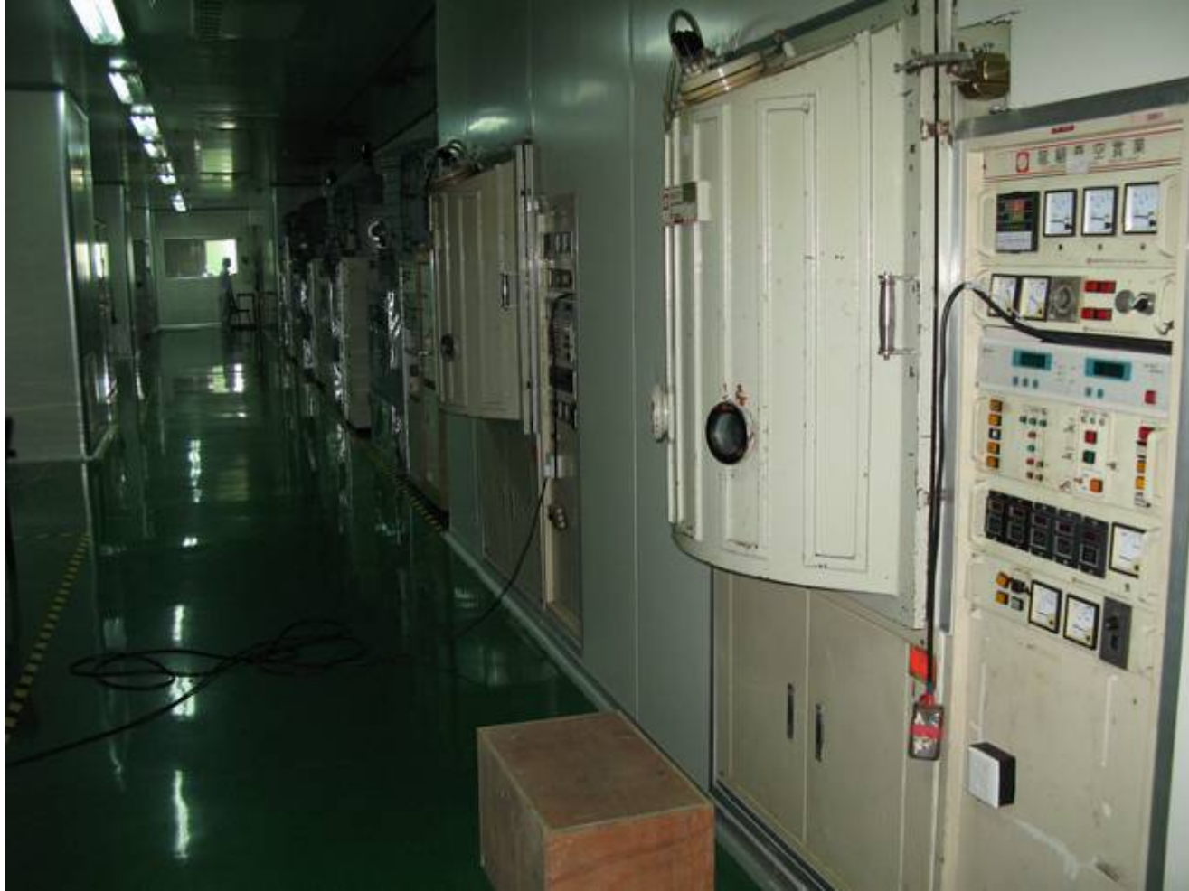
玻璃镜片镀膜机 多层镀膜机 6台 单层镀膜机 3台
