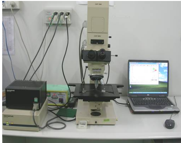
仪器名称:光谱仪 制造厂商:日本 仪器型号:USPM-RU 仪器数量:1台
