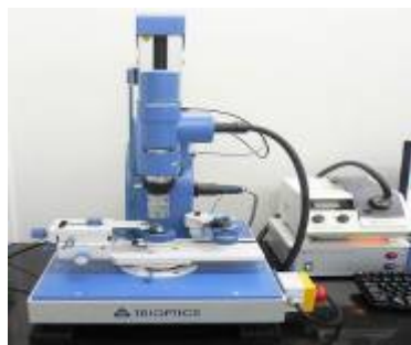
Trioptical 偏心仪 镜片偏心测试
